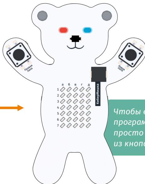
Чтобы выйти из режима программирования, нужно просто нажать любую из кнопок сброса.
